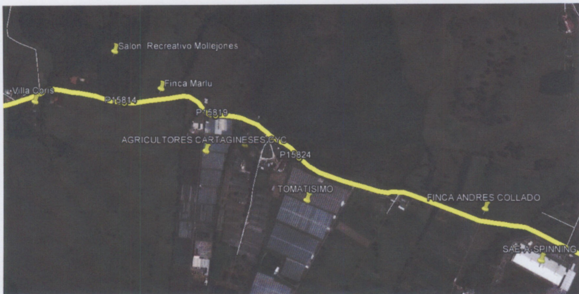
Figura N° 2. Tendido de la línea Semiaislada: Tramos 5, 6, 7
