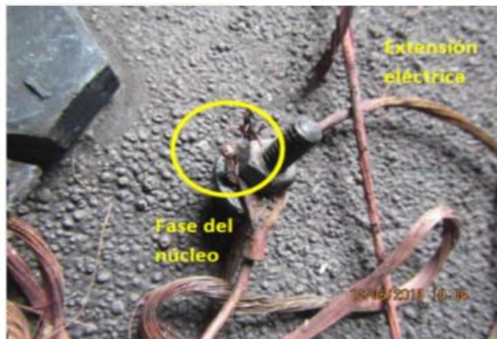
Al analizar los núcleos eléctricos internos de los transformadores, se puede apreciar que el transformador 1, presenta conductores eléctricos conectados a las fases, los cuales presentan daño eléctrico; mientras que el transformador 2, únicamente presenta daño por afectación térmica. ....
